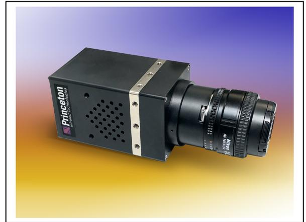
Esta cámara con detector de InGaAs/GaAsSb de tipo II (T2SL) permite obtener imágenes SWIR de alta resolución de 1280x1024 a una velocidad de 90 fotogramas por segundo (fps) a máxima resolución. El pequeño paso de la matriz de detectores de 12  $\mu\text{m}$  de la cámara combinado con la respuesta de longitud de onda ampliada de su material T2SL permite obtener imágenes impresionantes desde longitudes de onda visibles hasta 2050 nm.
